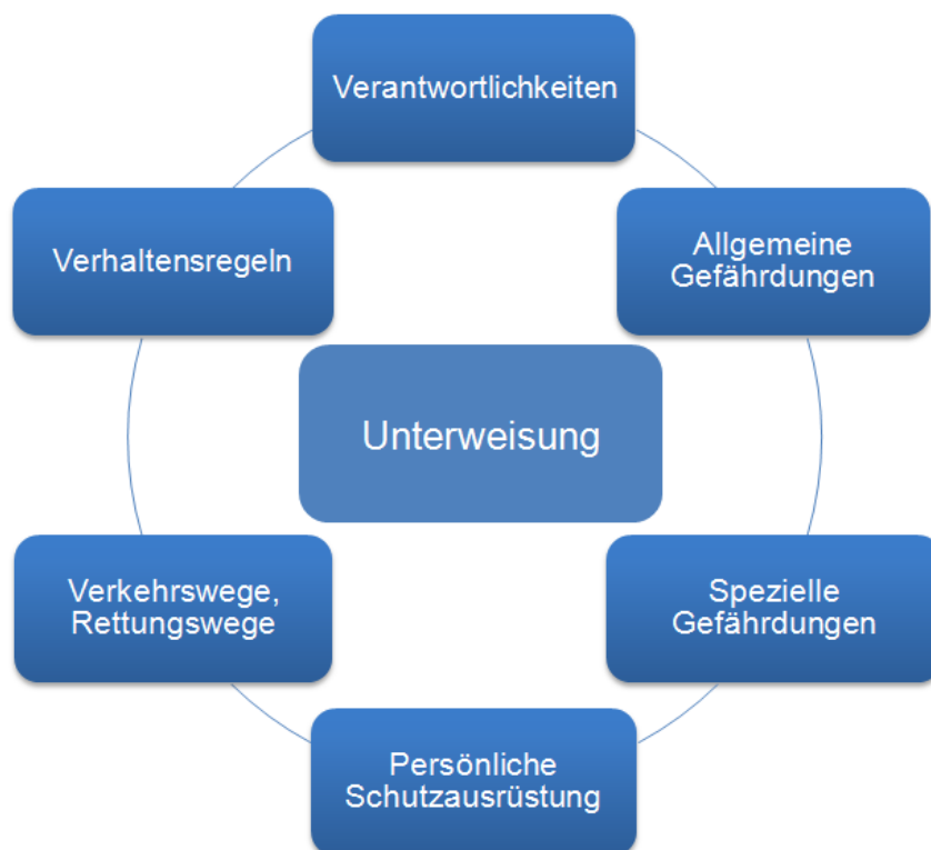
Abbildung 16: Mindestanforderung an eine Unterweisung auf einer Baustelle
