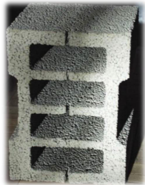
Abbildung 23: Beton aus Mauerwerksbruch [6]
